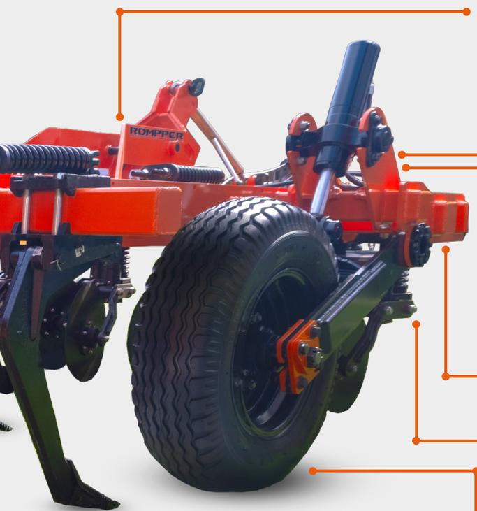
A disposição das hastes em **FORMATO DE "V"** dispersa os torrões e palhada, evitando o embuchamento e **OTIMIZANDO A EFICIÊNCIA** da operação.
